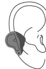
Hörsystem mit der schmalen Seite vorsichtig Richtung Gehörgang setzen. Leicht drehen, um es in die richtige Lage zu bringen. Mit dem Zeigefinger sanft in den Gehörgang drücken.
