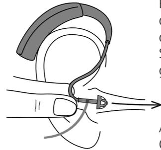
Hörsystem am Ende des Schlauchs kurz vor dem Schirmchen halten. Schirmchen in Gehörgang setzen.
