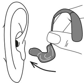
Hörsystem am Ende des Schlauchs kurz vor dem Ohrpasstück halten. Ohrpasstück in Gehörgang setzen.
