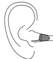
Hörsystem mit der schmalen Seite vorsichtig Richtung Gehörgang setzen. Leicht drehen, um es in die richtige Lage zu bringen. Mit dem Zeigefinger leicht in den Gehörgang drücken. Das CIC ist noch kleiner als das ITC und sitzt tiefer im Gehörgang.
