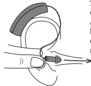
Das Einsetzen ist leichter, wenn man das Ohr mit der anderen Hand leicht nach oben und hinten zieht.
